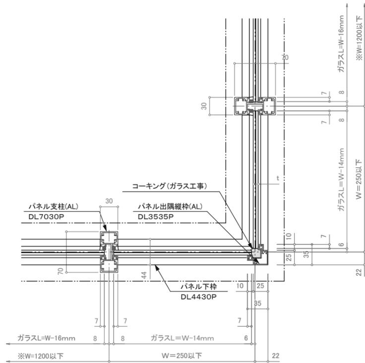
※注意: 支柱ピッチは水平荷重強度及び耐風圧強度により異なります。
