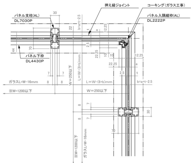
※注意: 支柱ピッチは水平荷重強度及び耐風圧強度により異なります。
