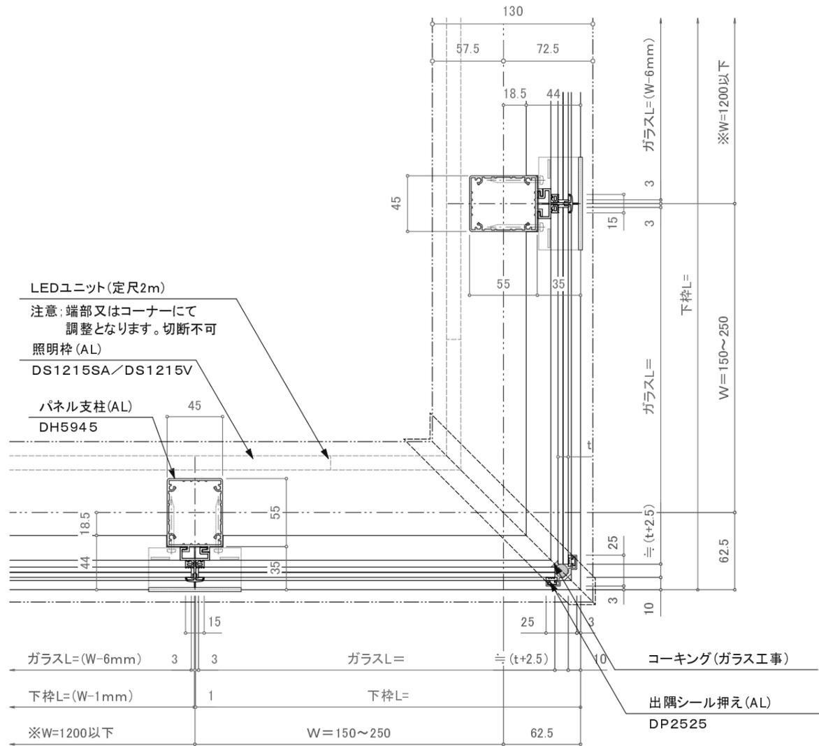
※注意: 支柱ピッチは水平荷重強度及び耐風圧強度により異なります。
