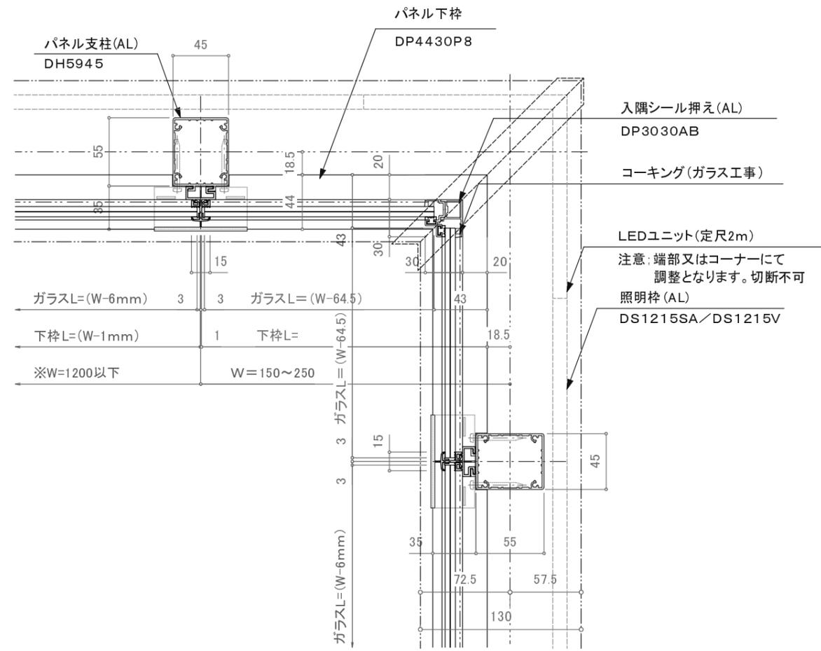
※注意: 支柱ピッチは水平荷重強度及び耐風圧強度により異なります。
